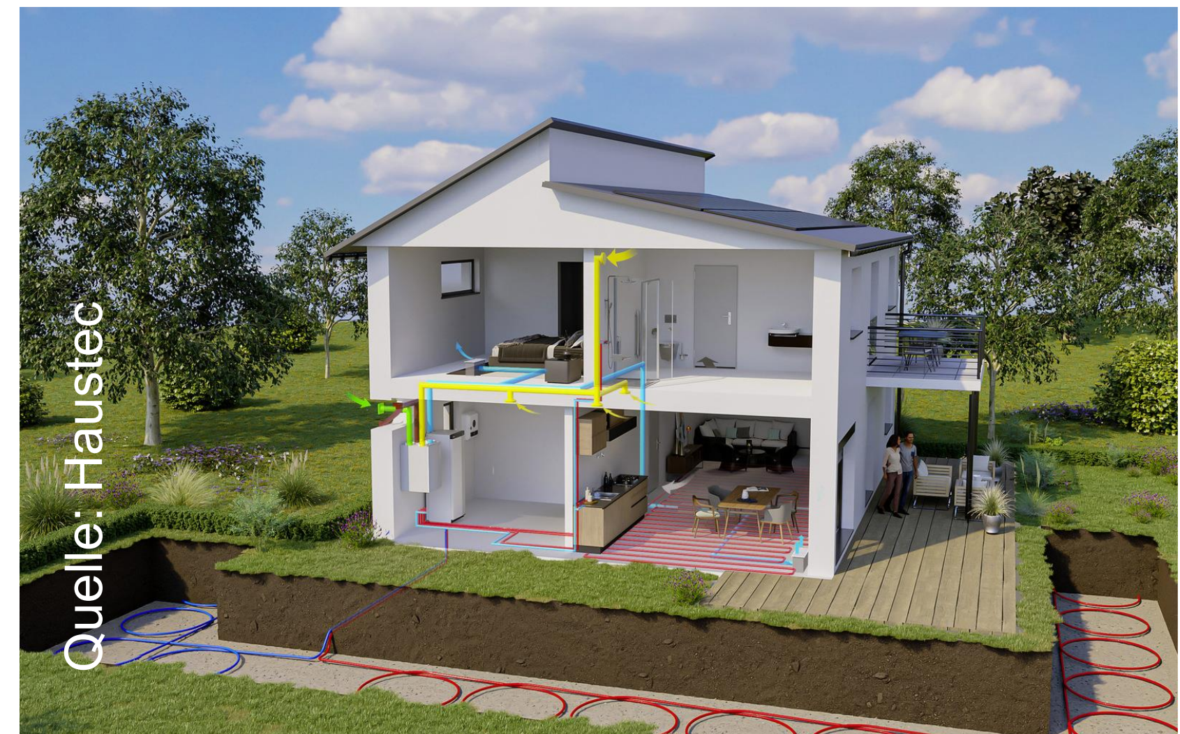
Für das obige Beispiel mit 9KW Heizlast: 2m tief; 1,4m breit und 90m lang
